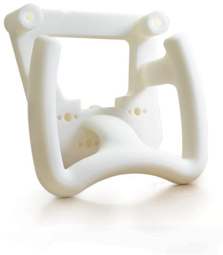
Die Abteilung für Werkzeuge und Vorrichtungen der BMW AG in Regensburg verwendet einen industrietauglichen Fortus® 3D-Drucker zur Herstellung von Montagewerkzeugen. Mit diesem Werkzeug wird der rückseitige Namensschriftzug befestigt.
