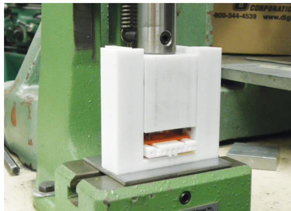
Ein Mitarbeiter von Xerox modifiziert an dieser Kniehebelpresse 350 Anschlüsse in etwa einer Stunde.
