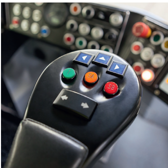
3D-gedruckte Armlehne mit drei zusätzlichen Bedienelementen für ein Kontrollsystem
